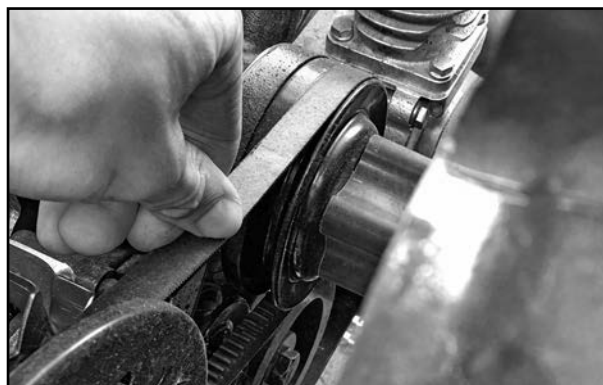
Рис. 5-9. Проверка и регулировка натяжения приводного ремня
