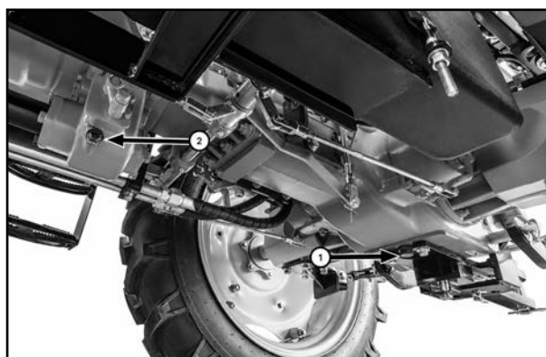
Рис. 5-11. Проверка уровня масла в трансмиссии 1 – масляный щуп трансмиссии.
